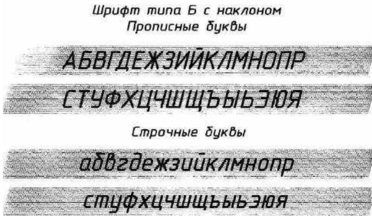
Рис.3 Вычерчивание букв и цифр по вспомогательной сетке. Шрифт типа Б с наклоном.
