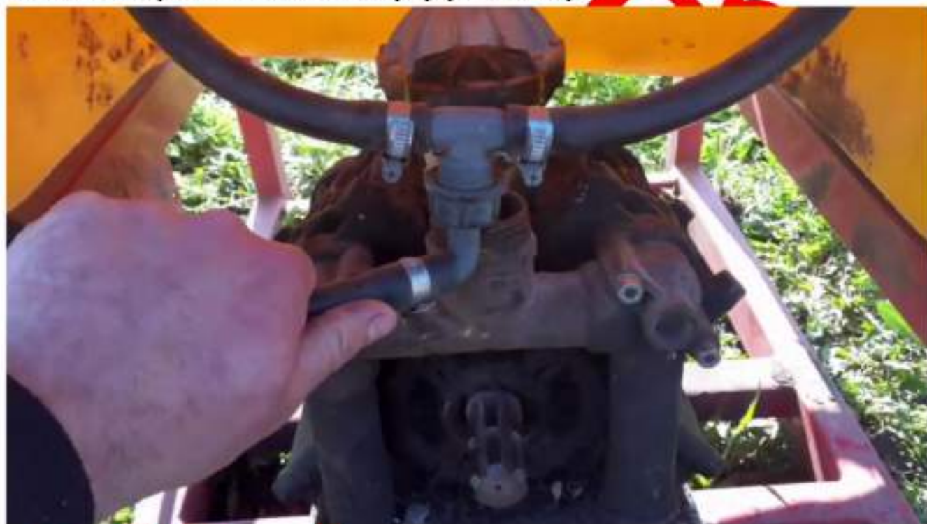
Рисунок 5.1 – Установка и регулировка насоса для опрыскивателя
