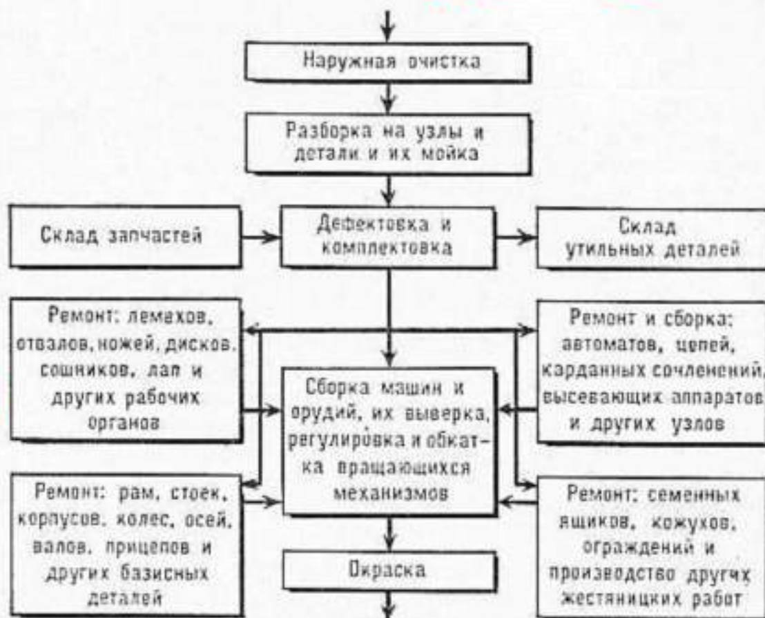
Рисунок 5.2 – Схема ремонта сельскохозяйственных машин в ЦРМ
